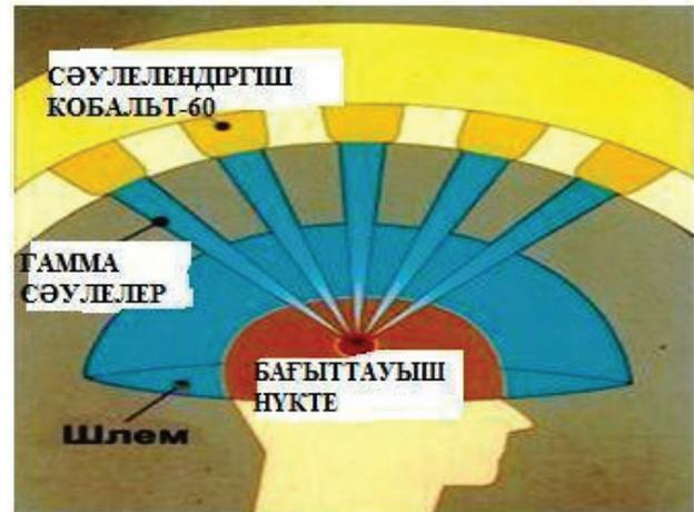
Сурет 1 - Сәулелендіргіш кобальт -60, гамма сәулелерінің бағыттаушы нүктесі
